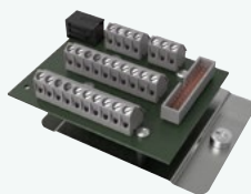
PCB opcional para funciones adicionales.
