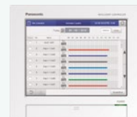
Controlador inteligente (pantalla táctil/servidor web) para controlar hasta 256 unidades interiores con relación de distribución de carga (LDR) incluida.
