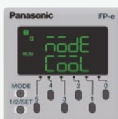
PCB para aplicación en sala de servidores, control de 3 unidades PACi, redundancia, respaldo, etc.
